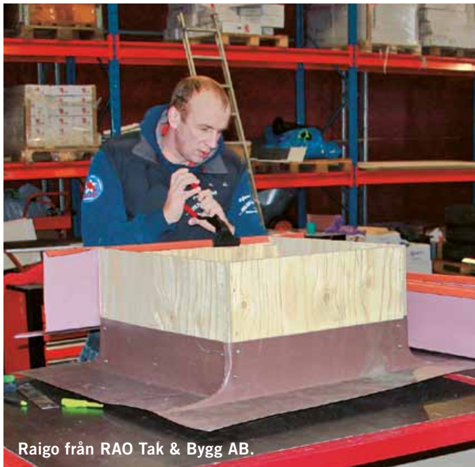
Raigo bockar plåt med hjälp utav Jouanel's kantmaskin, art.nr: JOPCX2040.
